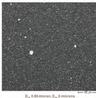
Figura 6. Carbonato de calcio recubierto con ácido esteárico dispersado en un termoplástico vía extrusión de doble husillo; ligera aglomeración.
