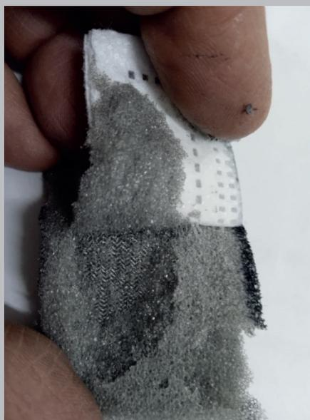
Una vez aplicado el adhesivo y antes de que se seque, se empalmaron los sustratos y se dejaron secar bajo presión por 24 horas. De igual manera, las muestras de adhesivo con y sin Vultac, se colocaron, se empalmaron y se calentaron a 150 °C por 5 minutos para determinar la diferencia con la adhesión en frío.
