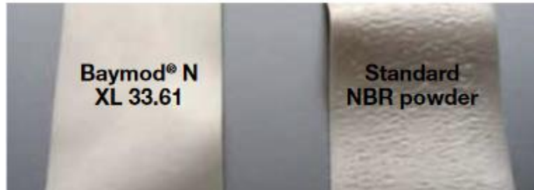
Compuesto extruido de PVC: con Baymod® N XL 33.61 comparado con polvo de NBR.
